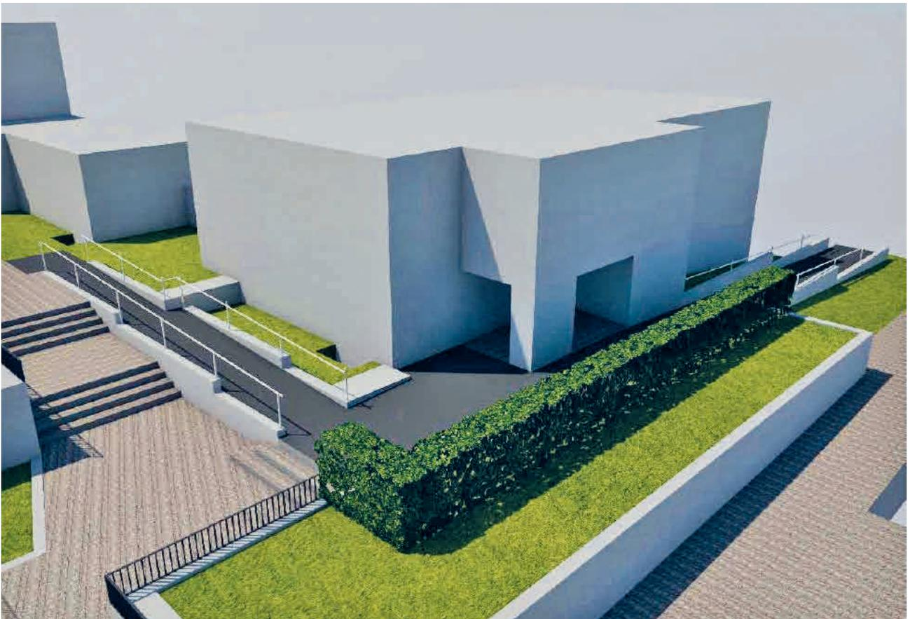
*Visualisierung: Die neue behindertengerechte Rampe wird ab dem Sägeweg hinter die bestehende Umfassungsmauer des Pfarrhauses gelegt. Die neue Rampe erschliesst damit zuerst das Pfarrhaus und ab dort die Kirche. Sie passt sich gut in das bestehende Ensemble ein.*
