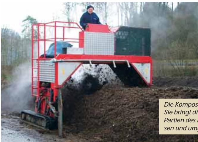
*Die Kompostwendemaschine im Einsatz. Sie bringt die stark erwärmten innern Partien des Kompostwalmes nach aussen und umgekehrt.*
